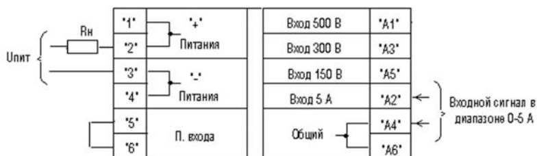
Рис. 1.4. Пример подключения для диапазона I_{вх} 0–5 А
