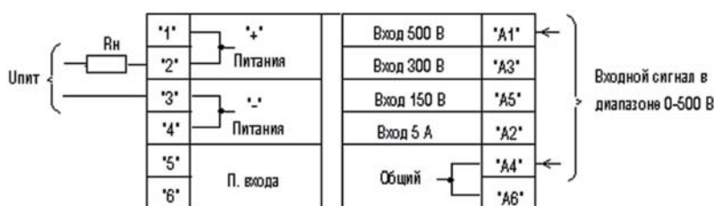
Рис. 1.1. Пример подключения для диапазона U_{вх} 0–500 В
