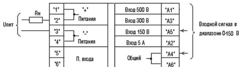
Рис. 1.3. Пример подключения для диапазонов U_{вх} 0–150 В
