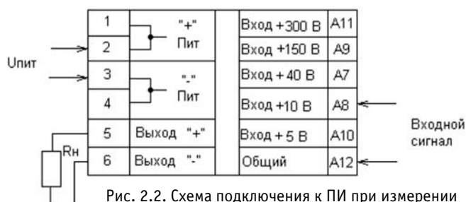
Рис. 2.2. Схема подключения к ПИ при измерении входного сигнала от 0 до 10 В
