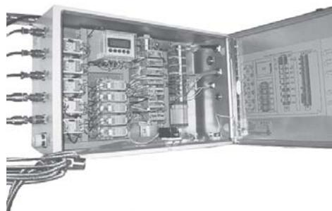
Конструктивное исполнение – компактный металлический шкаф с измерительными каналами и блоком (блоками) индикации и контроля (БИК), первичные преобразователи, соединительные жгуты, блоки индикации выносные для каждого канала.
