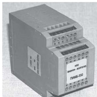
В корпусе преобразователя установлены печатные платы с навесными элементами. Для подключения источника входного сигнала, источника питания и сопротивления нагрузки на корпусе установлены клеммники. На боковой поверхности корпуса имеется отверстие, обеспечивающее доступ к регулировочному резистору при калибровке преобразователя.
