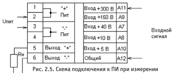
Рис. 2.5. Схема подключения к ПИ при измерении входного сигнала от 0 до 300 В
