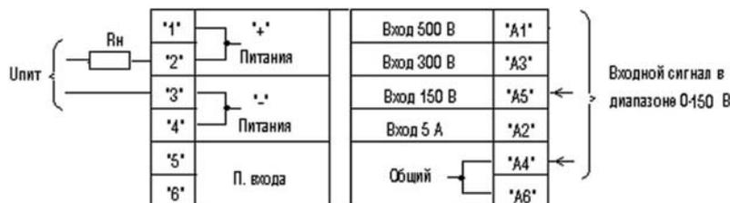
Рис. 1.3. Пример подключения для диапазонов  $U_{вх}$  0–150 В
