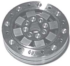
Муфта основного насоса гидравлики
